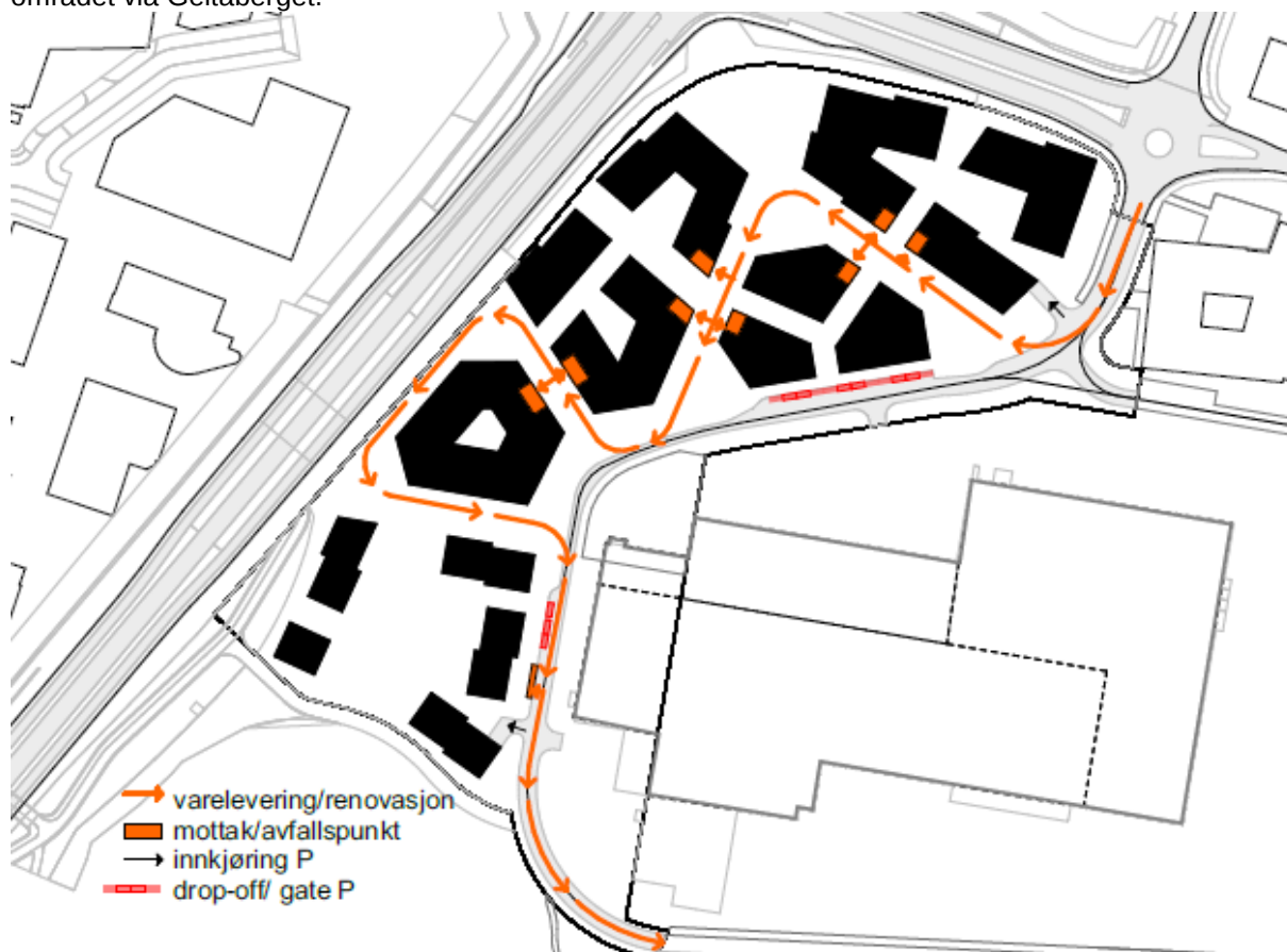
Figur 96 - Kjøremønster for varelevering og renovasjon
