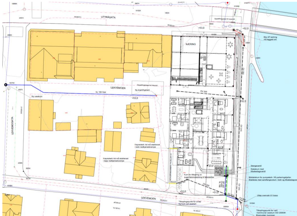
Figur 8181- Eksisterende og planlagt VA. Fra VA-rammeplanen
