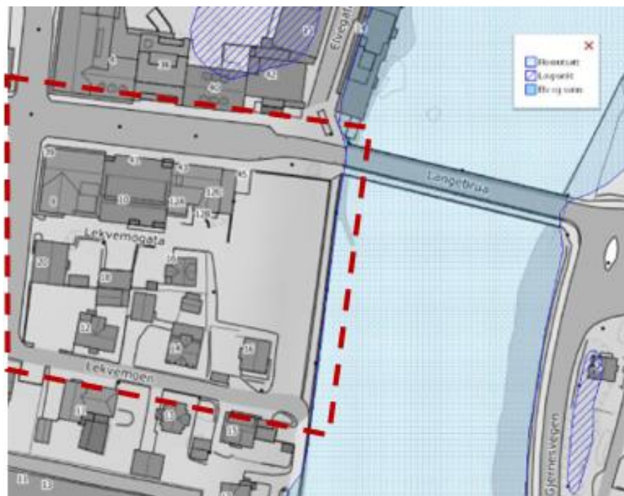
Figur 2624- Flomsone ved 200-årsflom. Fra VA-rammeplanen
