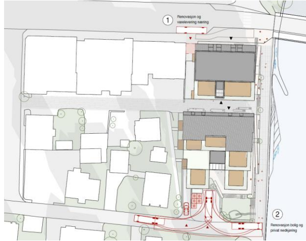
Figur 7776- Sporingskurve for renovasjonsbil. Fra illustrasjonsmaterialet
